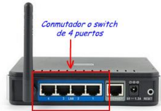
Vista posterior del router. Tiene integrado un conmutador de 4 puertos. En cada puerto se puede conectar un ordenador mediante un cable.
